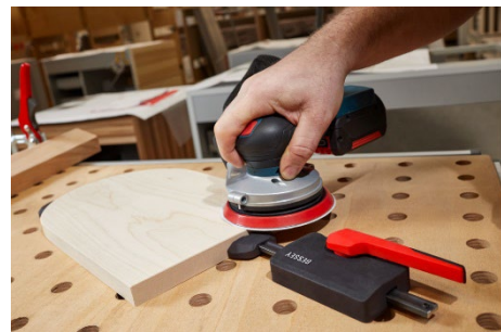
Der BESSEY Waagrecht-Niederzugspanner hält das Werkstück im gespannten Zustand plan auf der Tischfläche.
