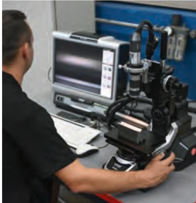
Erfahrenes Fachpersonal führt mittels Mikroskop mit bis zu 1000facher Vergrößerung Untersuchungen an Gefüge oder Reinheitsgrad durch.
