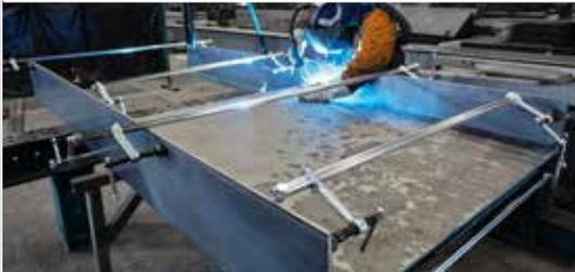
BESSEY offre, outre des ensembles de presses haute performance complètement montés, des accessoires combinables de multiples façons. Les coulisseaux pré-montés, permettant la fonction serrage, peuvent être modifiés facilement pour passer à la fonction écartement ou encore être complétés par d'autres.
